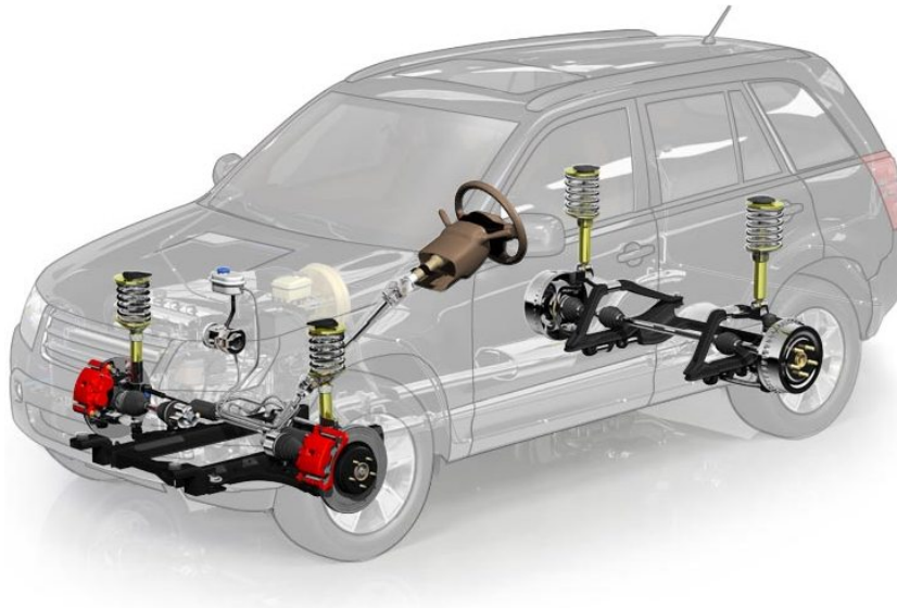
FIGURE 2 – Schéma de la suspension d'une voiture : notez les quatre ressorts.
