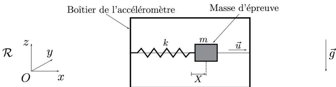
Figure 5 : Schéma d'un accéléromètre pendulaire.
