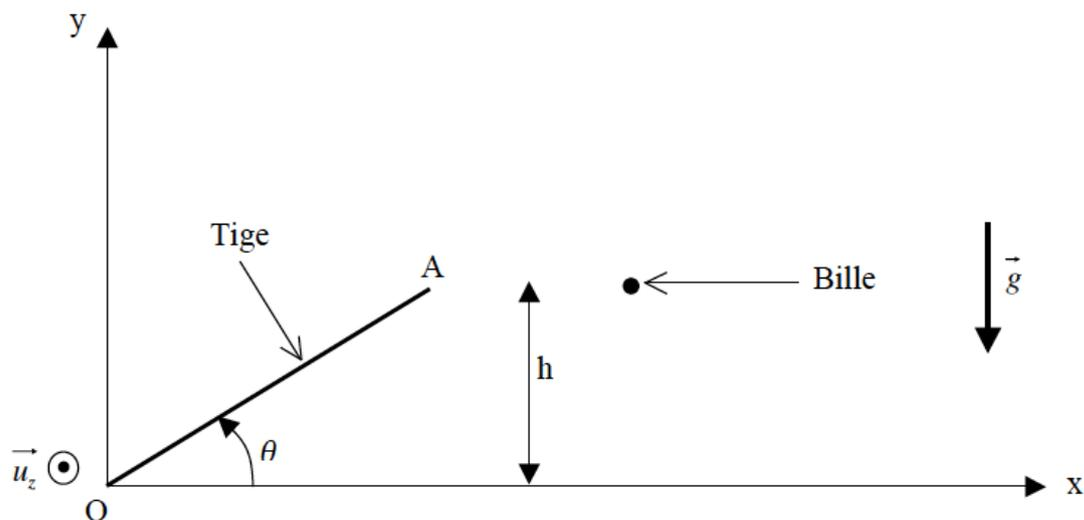
Une tige rigide de longueur  $l$  et de masse  $m$  peut tomber au sol en pivotant autour du point  $O$ . On la lâche, sans vitesse initiale, d'un angle initial  $\theta_0 = 30^\circ$ .
