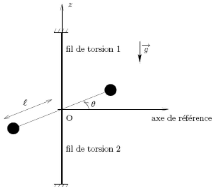
FIGURE 1 – Schéma du pendule de torsion étudié.
