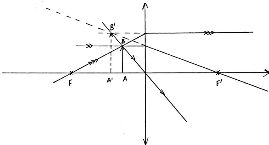
FIGURE 10 – Explication de la photographie de droite : à travers une lentille convergente, le texte apparaît agrandi et à l'endroit (si la lentille était divergente, il serait rétréci et à l'endroit).
