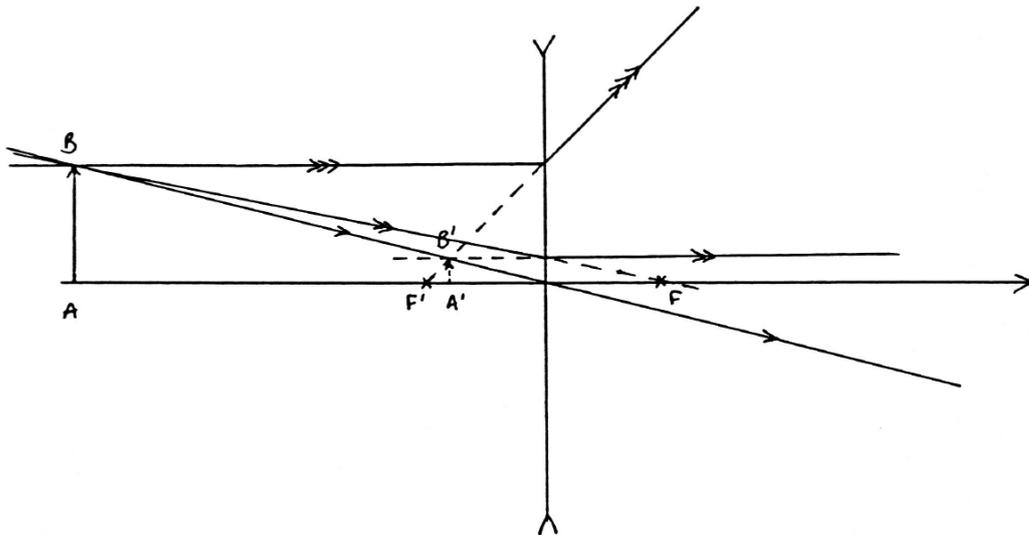
FIGURE 9 – Explication de la photographie de gauche : à travers une lentille divergente, des objets lointains paraissent rétrécis et à l'endroit (si la lentille était convergente, ils seraient rétrécis et à l'envers).
