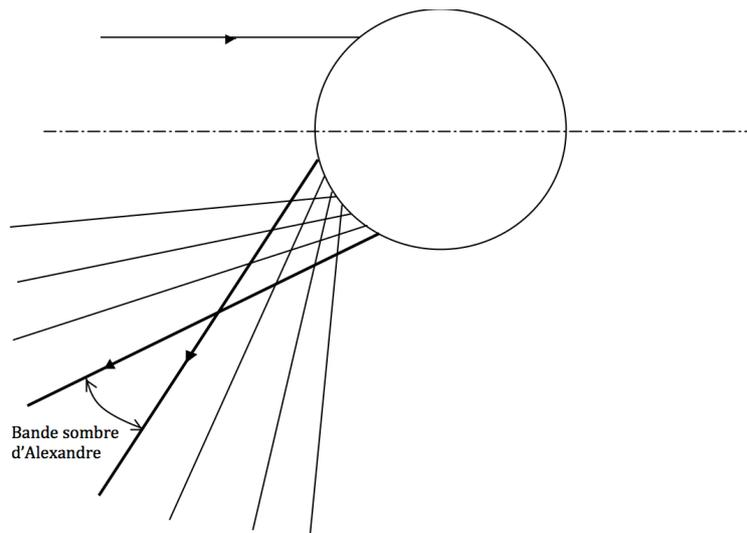
FIGURE 3 – Toute la lumière sortant de la goutte pour une et deux réflexions, mettant en évidence une zone où il n'y a pas de rayons émergents (cette figure est la superposition des deux précédentes).
