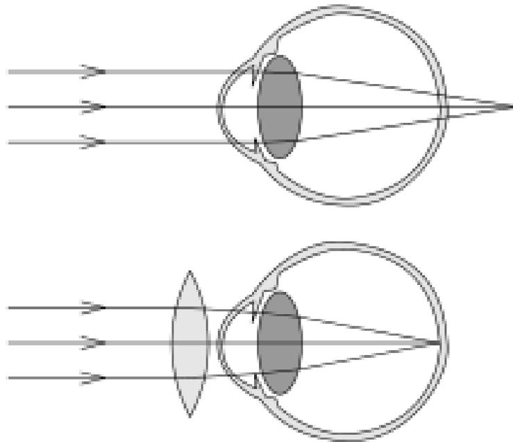
FIGURE 8 – Oeil hypermétrope non corrigé et corrigé.
