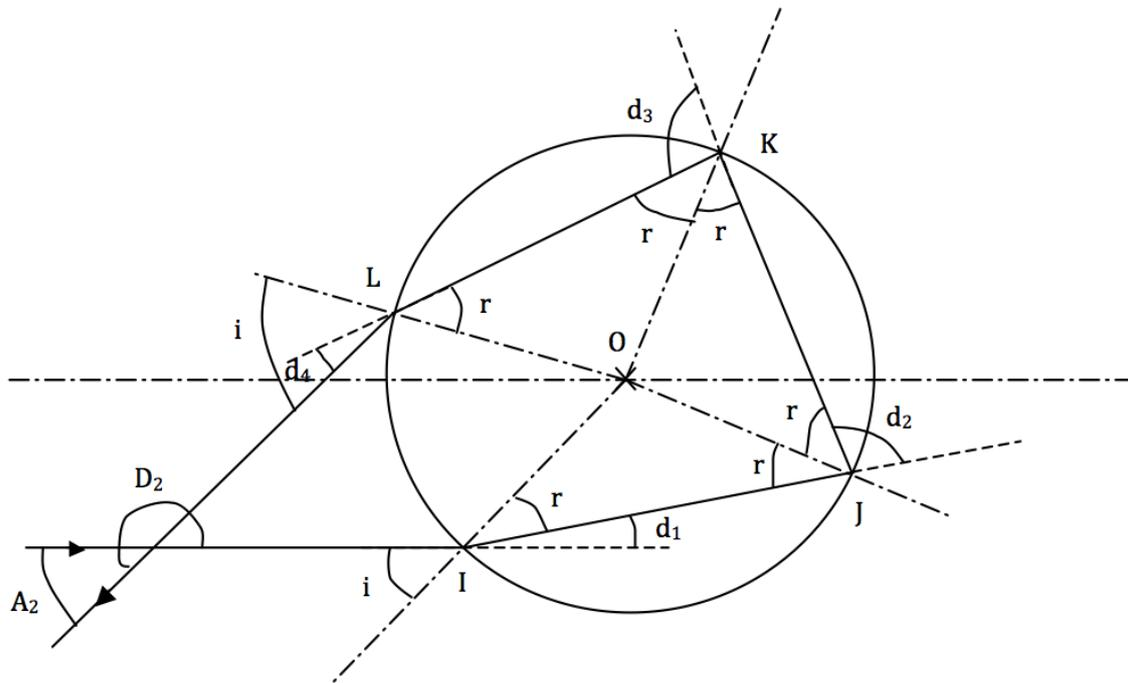
Remarquons tout d'abord que, les normales à la surface de la goutte passant par son centre  $O$ , les triangles  $OIJ$ ,  $OJK$  et  $OKL$  sont isocèles. De plus, comme lors d'une réflexion, l'angle d'incidence est égal à l'angle de réflexion (si on ne les oriente pas), tous les angles que font les rayons lumineux avec les normales à l'intérieur de la goutte sont égaux à  $r$ .
