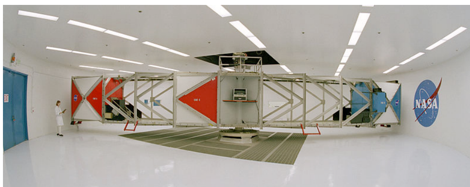
Centrifugeuse humaine 20 g au centre de recherche « Ames » de la NASA en Californie
