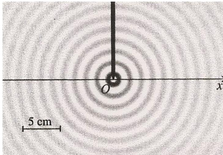
La figure ci-dessus représente la surface d'une cuve à onde éclairée en éclairage stroboscopique. L'onde est engendrée par un vibreur de fréquence  $f = 18 \text{ Hz}$ . L'image est claire là où la surface de l'eau est convexe, foncée là où elle est concave.
