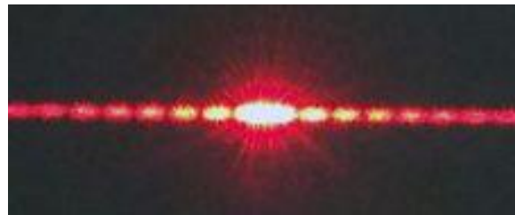
FIGURE 11 – Diffraction d'un faisceau LASER rouge par une fente
